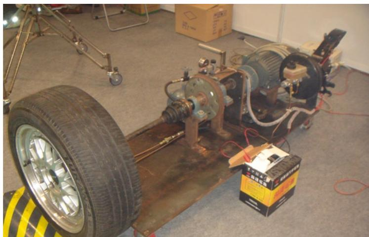
新式煞車系統實體圖
